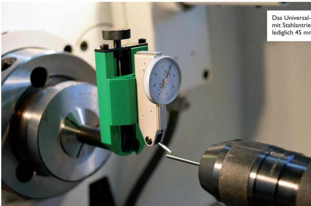
Das Universal-Auskreisgerät ist aus haltbarem Aluminium mit Stahlantrieben und verfügt mit einem Aufbau von lediglich 45 mm über eine sehr kompakte Bauweise.
